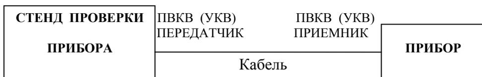
Рис. 7.7 Схема подключения прибора к стенду СП-1А.
