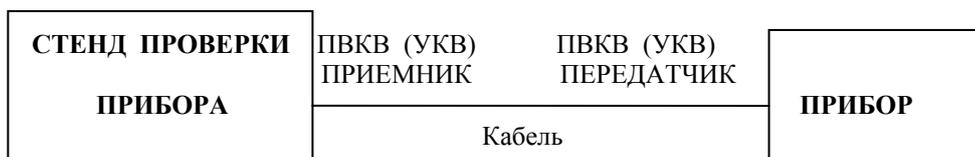
Рис . 7.6. Схема подсоединения прибора к стенду СП-1А.
